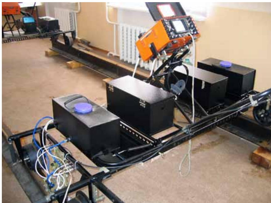
Дефектоскоп УДС2-РДМ2 после ремонта
