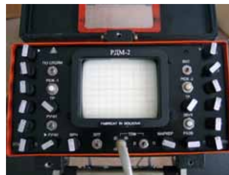
Электронный блок съемного рельсового дефектоскопа УДС2-РДМ-2 до и после проведения среднего ремонта.
