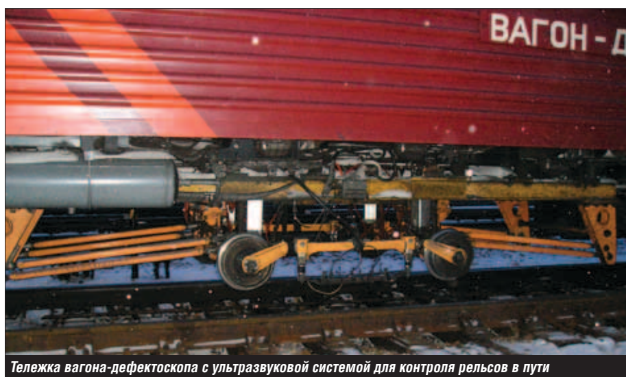
Совмещенный вагон-дефектоскоп "ВД-1МТ" для скоростного неразрушающего контроля рельсов типа Р-50, Р-65, Р-75
