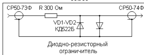
Рис. 20. Стенд для измерения частоты дефектоскопа и параметров наклонных ПЭП
